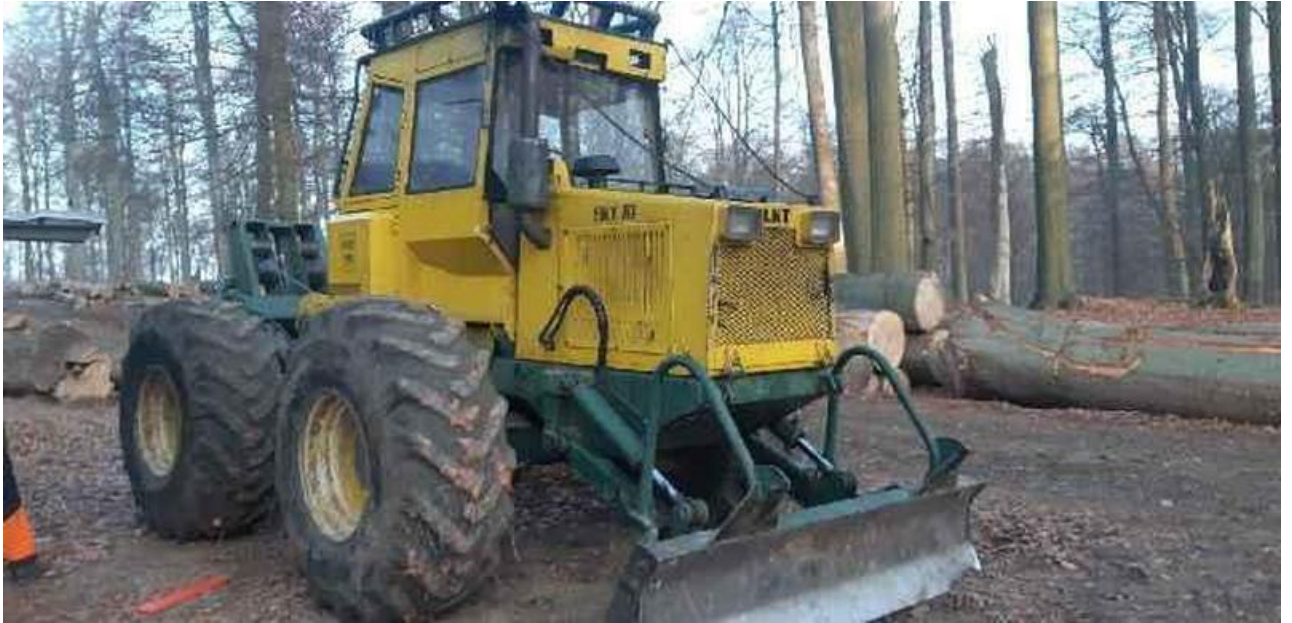
Рисунок 1.2 – Машина для трелювання (колісна формула 4x4) чокерного виду, марки LKT 81 T (Словаччина) [1-12]
