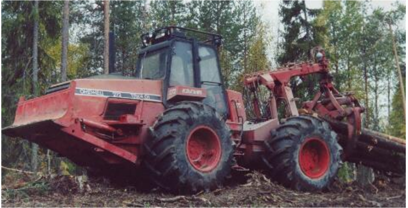
Рисунок 1.5 – Трелювальна колісна машина ТЛК 4-01
