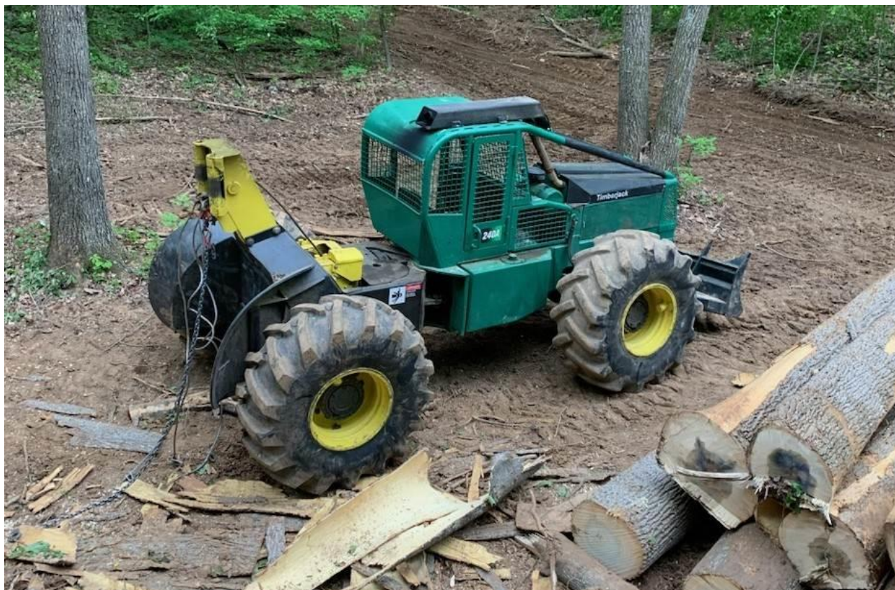
Рисунок 1.1 – Машина трелювальна Timberjack 240С із устаткуванням чокерного типу
