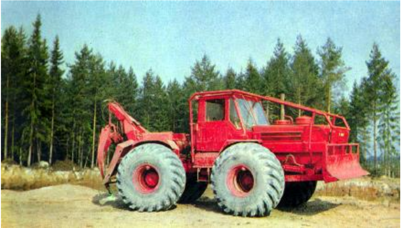
Рисунок 1.4 – Колісна трелювальна машина ЛТ-171 з пачковим затискачем
