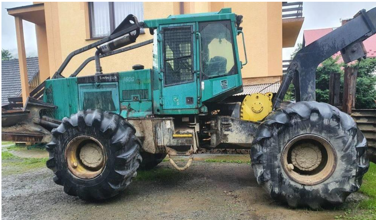
Рисунок 1.3 – Потужна трелювальна машина безчокерного типу Timberjack 460 , обладнана поворотним затискачем пачки і одинарною стрілою
