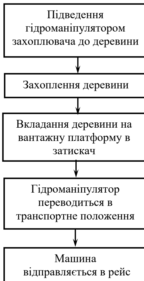
Рисунок 2.1 – Структурна схема роботи модернізованої трелювальної машини
