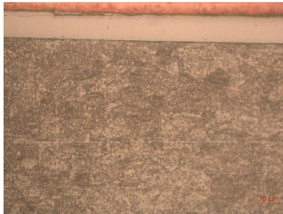
Рис. 1. Мікроструктура сталі аустенітного класу з покриттям CrN до випробувань
