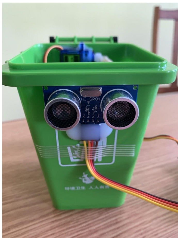
Рисунок 3.8 – Приєднання ультразвукового датчика до ємності
