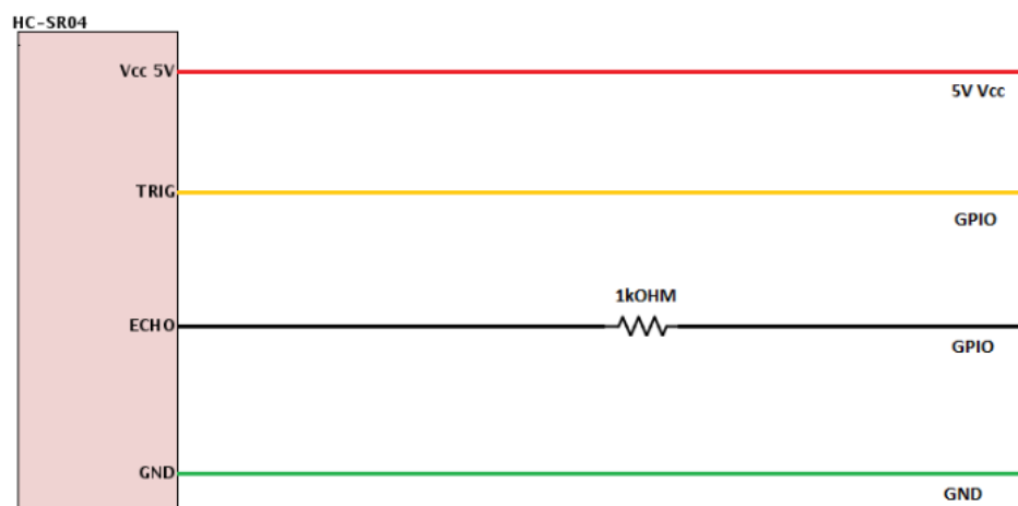
Рисунок 3.2 – Використання резистора для знизження напруги
