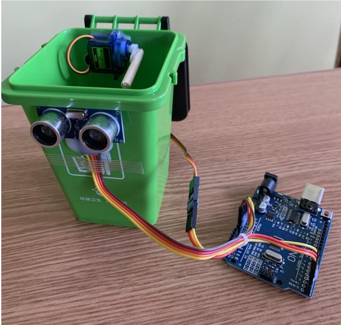
Рисунок 3.9 – З'єднання всіх складових з мікроконтролером
