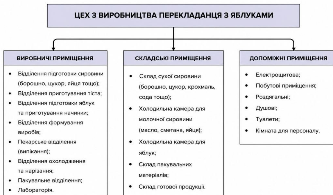
Рисунок 3.1 - Приміщення виробничі, складські та допоміжні, які знаходяться у цеху з виробництва перекладанця з яблуками
