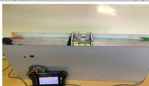
Схема та загальний вид установки для визначення коефіцієнтів тертя: 1 – стіл-майданчик; 2 – коробка; 3-досліджувана сировина; 4 – вантаж; 5 – сталевий пластинка; 6 – тензодатчик; 7 – трос; 8- кінцевий вимикач; 9 – блок; 10 – мотор-редуктор; 11 – блок управління
