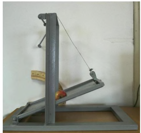
Рисунок 3.2 – Схема та загальний вигляд приладу для визначення кутів природного укосу та тертя сталевій поверхні: 1 – сталевий лист; 2 - горизонтальна станина; 3 – вертикальна опора; 4 – кінцевий блок; 5 – проміжний блок; 6 – секторний механізм; 7 - нитка для приводу сталевий листа
