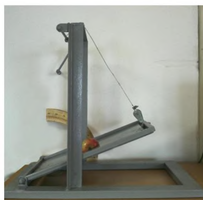
Схема та загальний вигляд приладу для визначення кутів природного укусу та тертя сталевій поверхні: 1 – сталевий лист; 2 - горизонтальна станина; 3 – вертикальна опора; 4 – кінцевий блок; 5 – проміжний блок; 6 – секторний механізм; 7 - нитка для приводу сталевий листа
