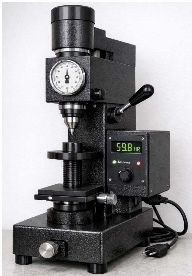
Рисунок 1.1 – Твердомір ТШ-ISO-2 для контролю твердості гумових зразків за міжнародними стандартами [1]
