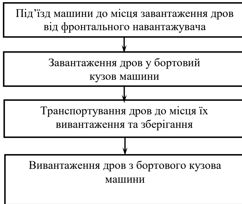
Рисунок 2.1 – Структурна схема роботи модернізованої машини для переміщення дров
