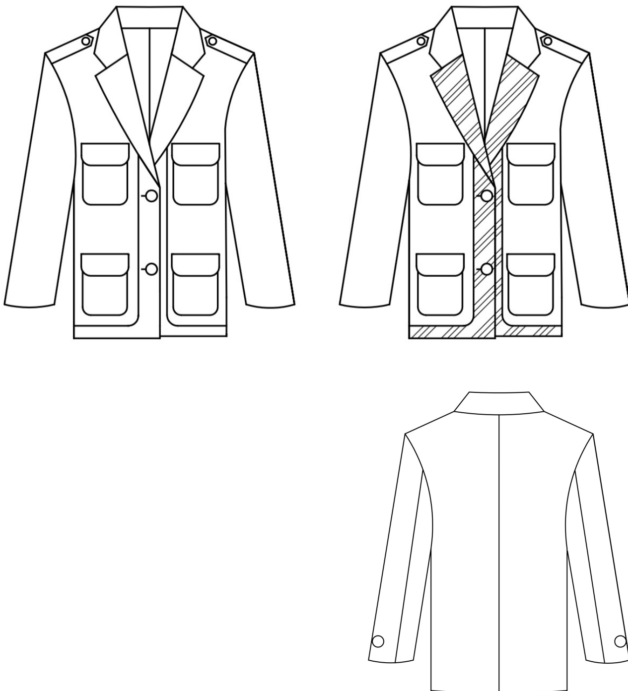
Рисунок Б 1.1 - Технічний рисунок жіночого жакету прямого силуету, розробленого з використанням fashion-рішень стилю сафарі
