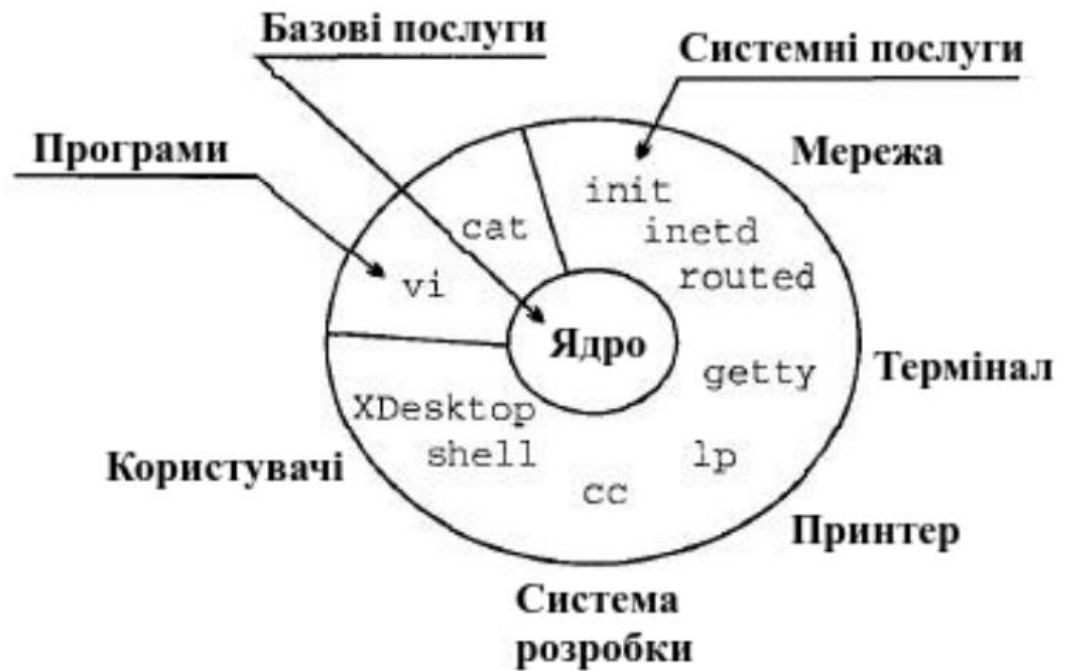
Рисунок 2.5 – Спрощена модель системи Unix
