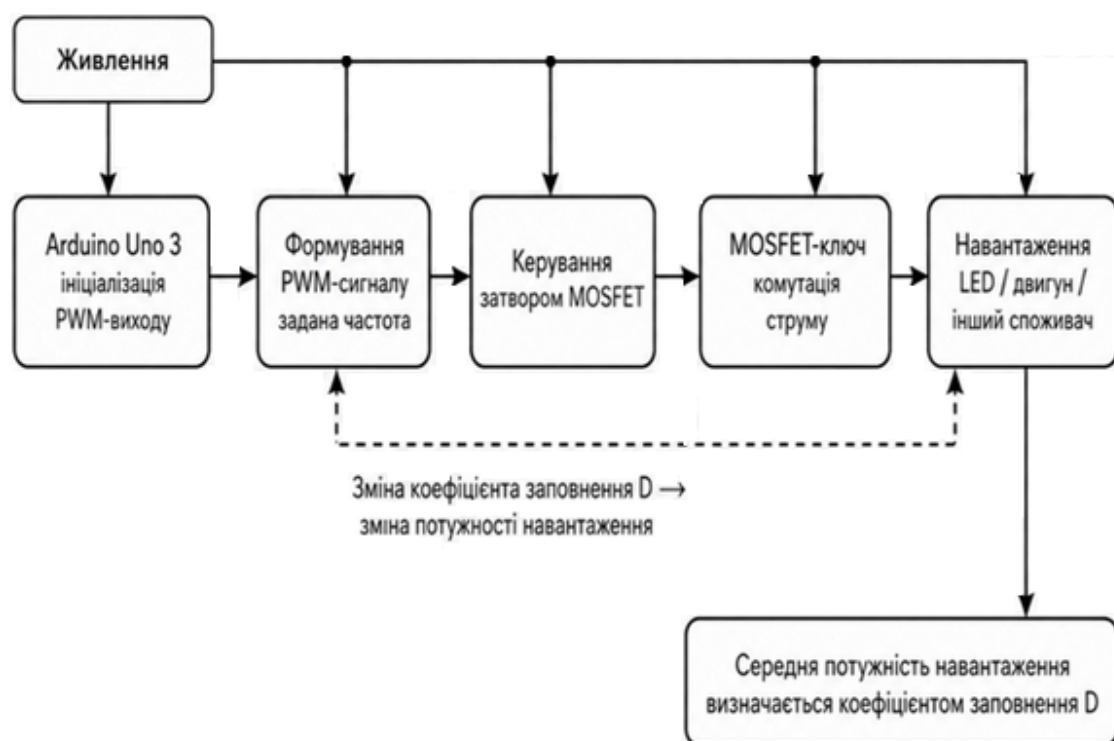
Рисунок 2.2 – Функціональна схема проходження сигналів у системі PWM-керування
