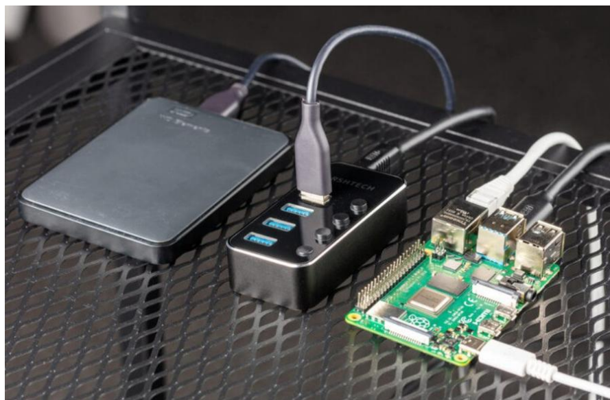
Рис. 5. Апаратна реалізація NAS: Raspberry Pi 4, USB-хаб та зовнішній HDD-накопичувач
