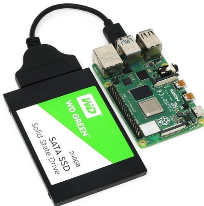
Рис. 4. Raspberry Pi 4 з підключеним SSD-накопичувачем через USB 3.0 адаптер
