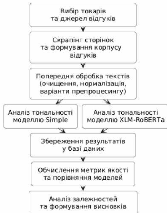
Рисунок 3.1 – Схема експериментального дослідження інтелектуальної системи аналізу відгуків на товари
