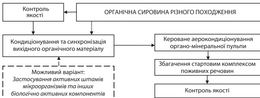
Рис. 5.5. Принципова схема технології виробництва твердих ОМД
