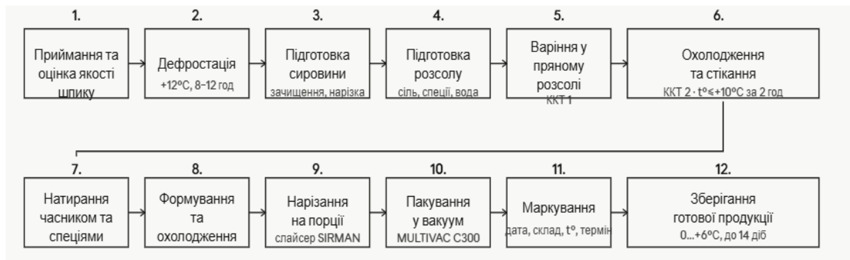
Рисунок 2.1 – Технологічна схема виробництва закуски із сала по-домашньому Джерело: розроблено автором
