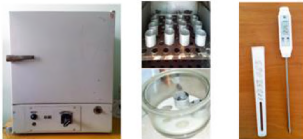
Рисунок 3.1 – Обладнання для дослідження вологості природно зневодненого сапропелю: сушильна електрошафа СНОЛ– 3,5.3,5.3,5/3 ИЗ; ексикатор із бюксами; термометр електронний TFA 301018
