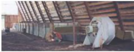
Рисунок. 1.7 – Фото та схема технологічного процесу сушіння зернового матеріалу у напільній сушарці: 1 – паливний агрегат; 2 – сушильна камера.
