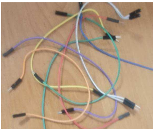
Рисунок 2.11 – З'єднувальні провідники (Dupont) для роботи на макетній платі
