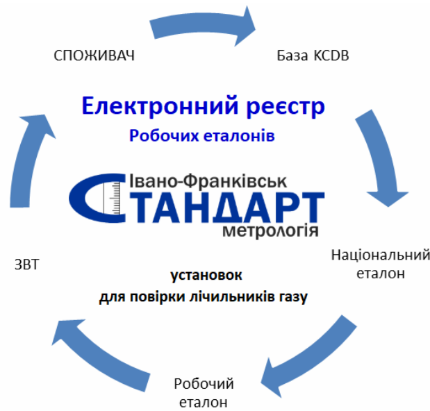
Рис. 1. Схема метрологічної простежуваності засобів вимірювання об'єму та об'ємної витрати газу в Україні
