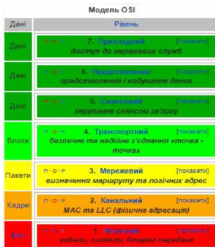
Рисунок 1.6 – Вигляд моделі OSI [3]
