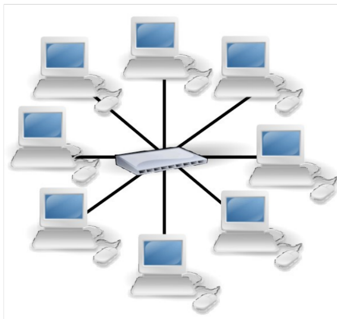
Рисунок 1.1 – Приклад топології «Зірка» [6]
