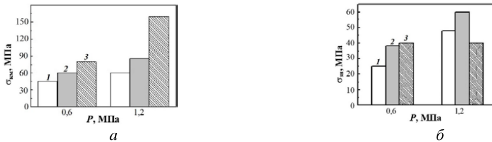
Рисунок 2 – Когезивна міцність \sigma_{KM} (а) та залишкові напруження розтягу \sigma_{ZH} (б) для покриттів з ПД 70Х18Р3 (1), ПД Х18Р3С2 (2) та ПД Х6Р3Ю3Мg2 (3), отриманих при двох значеннях (0,6 та 1,2 МПа) тиску повітряного потоку.
