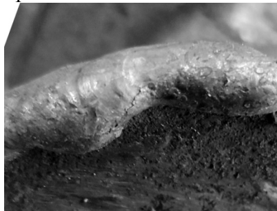
Рисунок 1 – Фрагмент лопаті шнека з напавленою поверхнею без повзунів.
