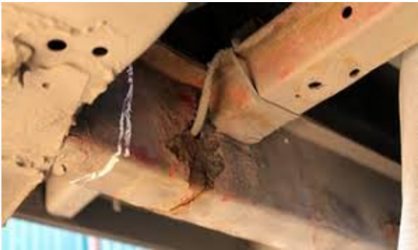
Рис. 1 – Поява тріщини у балці лонжерона автомобіля
