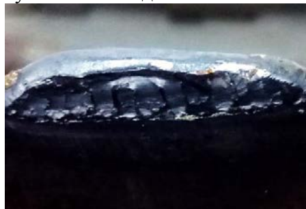
Рисунок 2 – Фрагмент лопаті шнека після наплавлення з використанням повзунів.
