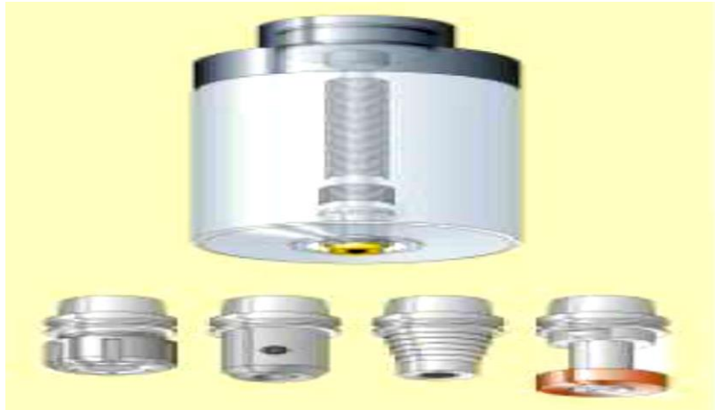
Рис.9.12. Вбудована система затиску HSK за стандартом DIN 69893
