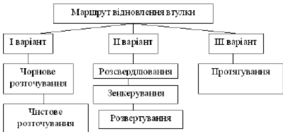
Рисунок 2. 2 – Варіанти технологічного ходу реновації рукавів
