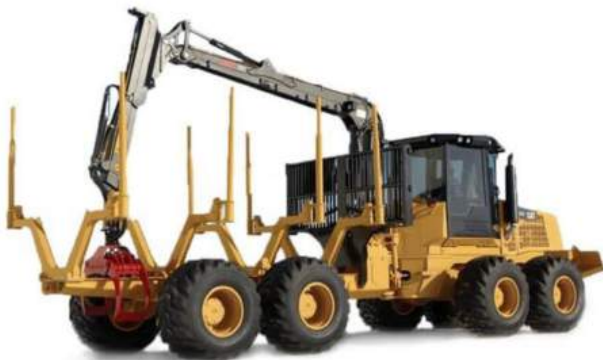
Рисунок 1.3 – Машини, які застосовуються в механізованій технологічній схемі рубок головного користування: а – харвестер; б – форвардер
