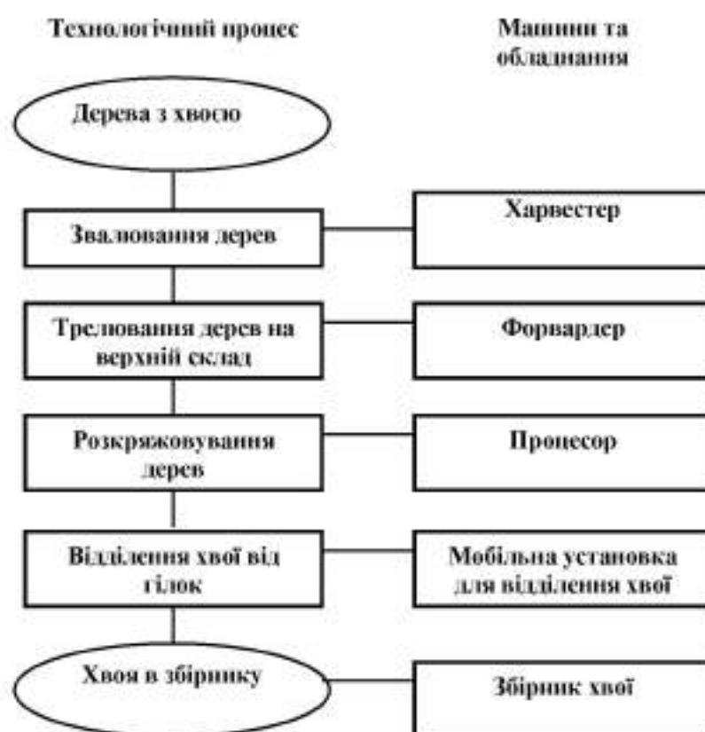
Рисунок 4.1 – Інтегрована технологія заготівлі хвої під час рубок головного користування
