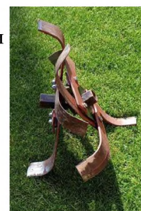
Однорядні фрези для обробітку міжряддя
