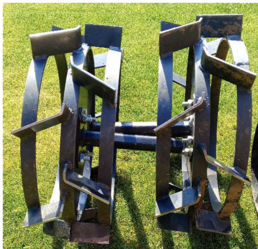
Рисунок 3.3 – Грунтозачеми для виконання оранки
