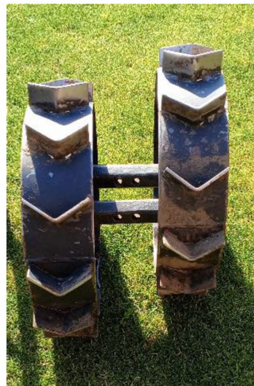
Рисунок 3.3 – Грунтозачеми для нарізання борозн при посадці
