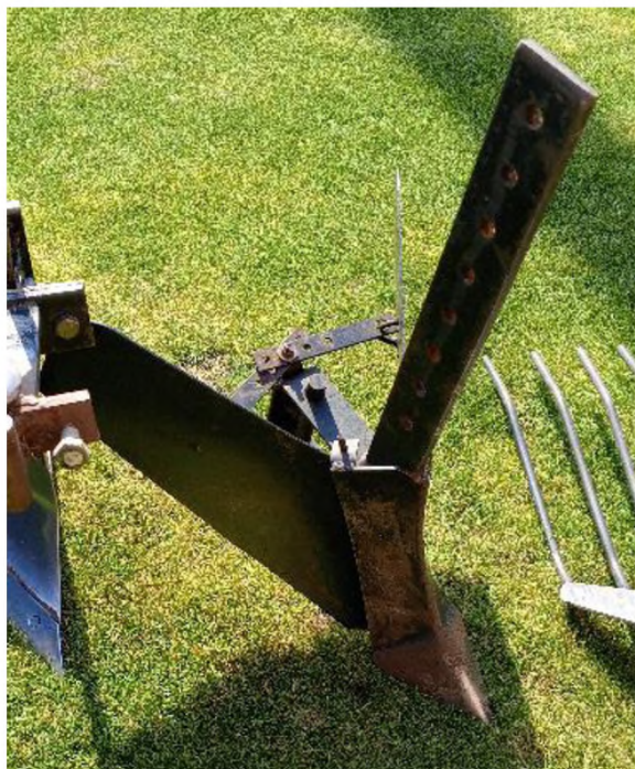
Рисунок 3.5 – Підгортач типу «Стріла-2»
