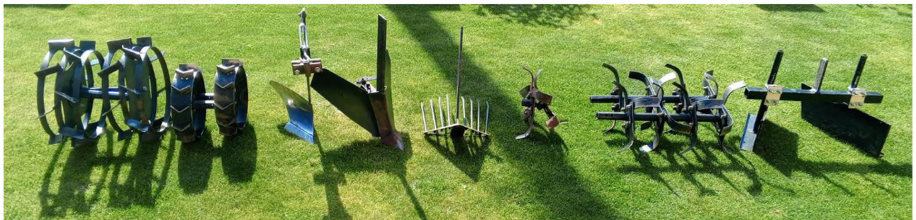
Рисунок 3.2 – Лінійка навісного обладнання для вирощування картоплі з застосуванням мотоблоку у якості енергетичного засобу
