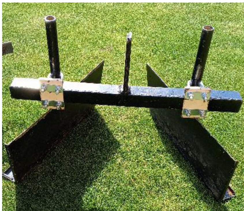
Рисунок 3.8 – Пристрій для загортання гребенів картоплі
