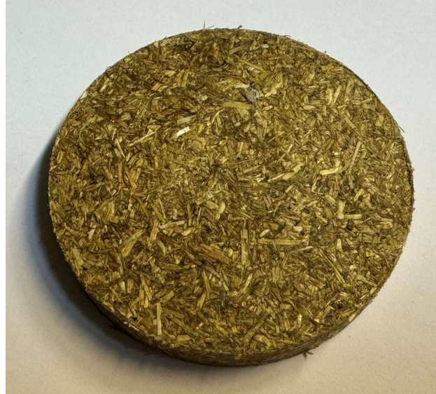
Рисунок 2.2 – Загальний вигляд біокомпозитного зразка для визначення твердості
