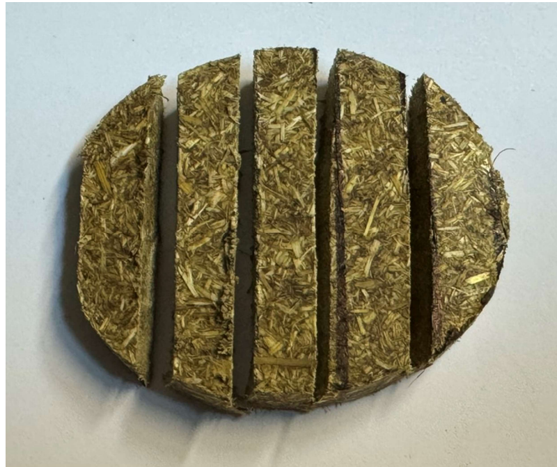
Рисунок 2.5 – Загальний вигляд біокомпозитних зразків для визначення ударної в'язкості
