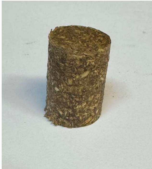
Рисунок 2.3 – Загальний вигляд біокомпозитного зразка для визначення міцності на стискання
