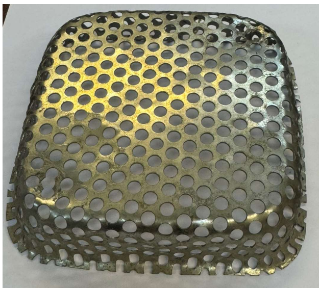
Рисунок 2.9 – Перфоровані пластини з отворами розміром 7 мм (а) та 3 мм (б)
