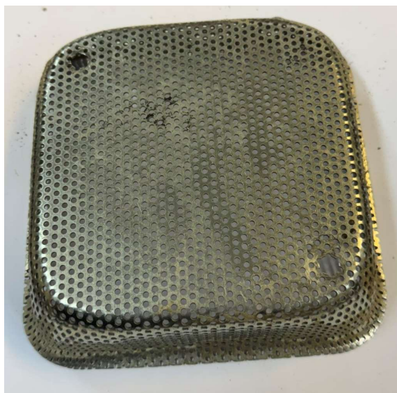
Рисунок 2.9 – Перфоровані пластини з отворами розміром 7 мм (а) та 3 мм (б)
