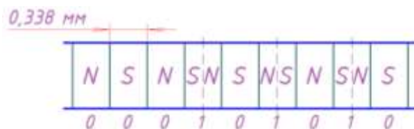
Рисунок 3.21 – Поляризація магнітного поля на доріжці
