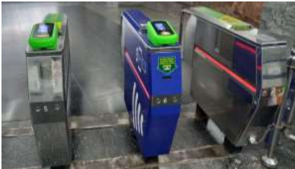
Рис. 7.9 – Нормальновідкритий турнікет, який використовується в метро
