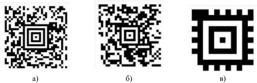
Рисунок 3.13 – Приклади штрихового коду сімейства Aztec а) – Full Aztec; б) – Compact Aztec та в) – Aztec Rune
