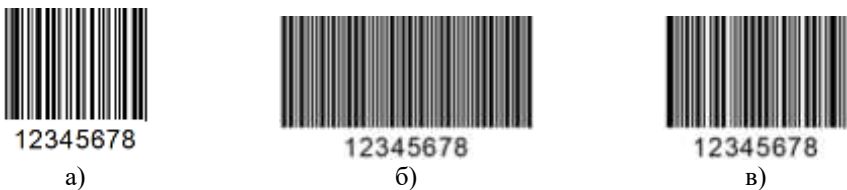
Рисунок 3.9 – Приклади штрихового коду сімейства 2 of 5 а) – Interleaved; б) – Industrial та в) – Matrix
