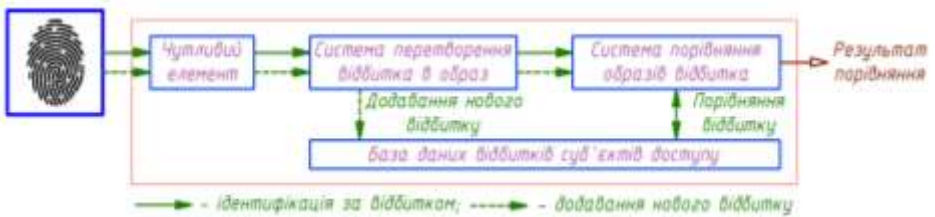
Рисунок 4.1 – Структурна схема зчитувача відбитка пальців
