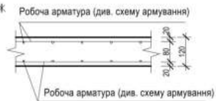
Рис. 2.16. Влаштування плити перекриття Пм-1, низ на відм. + 3,000 (опалубковий план, армування плити у верхній і нижній зонах)
