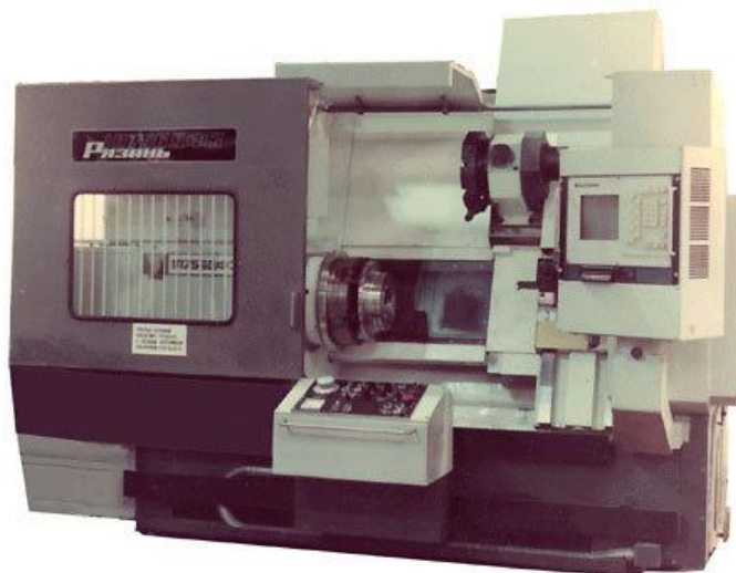
Рисунок 1.2 Напівавтомат багатоцільовий токарно-револьверний прутково-патронний 1П756ДФ3
