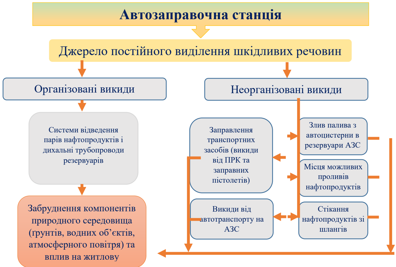
Рисунок 2.1 – Джерела організованих і неорганізованих викидів на автозаправній станції та їх вплив на компоненти довкілля
