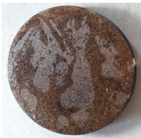
Рис. 1. Загальний вигляд поверхні біокомпозитного матеріалу без обробки (а) та з обробкою бензином (б)
