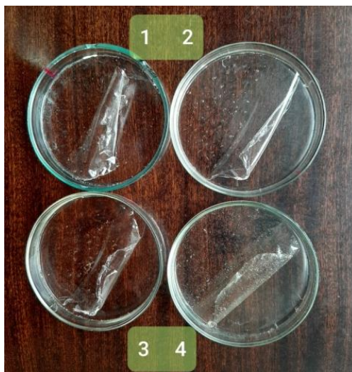
Рис.1. Плівки на основі полівінілового спирту: 1- Polyviol 6 04/140, 2-Polyviol W 25/100, 3- Polyviol M 13/140, 4 - ПВС 55/12.
