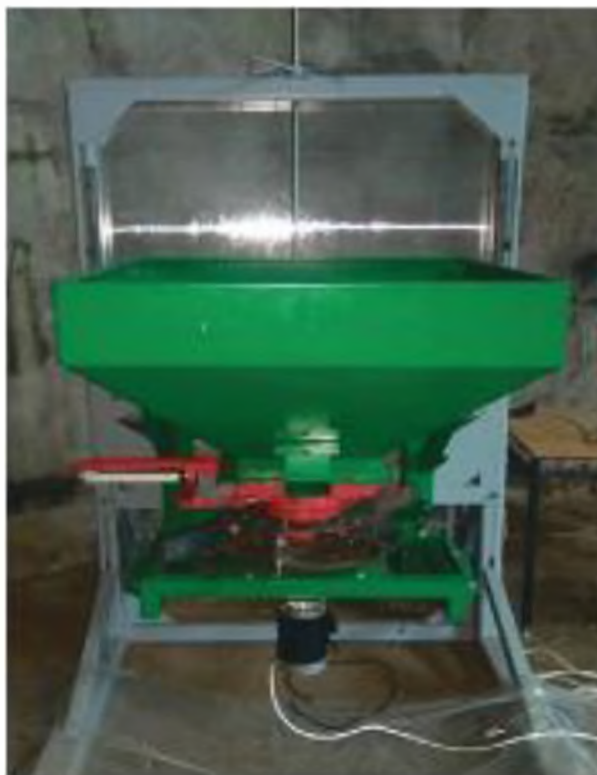
Рисунок 3.2 – Розроблений лабораторний стенд розподільника твердих мінеральних добрив
