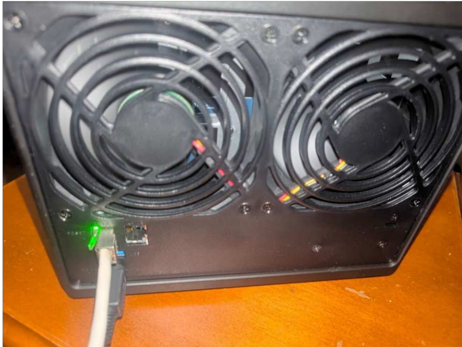
Рисунок 3.2 – Підключення до мережі за допомогою виті пари
