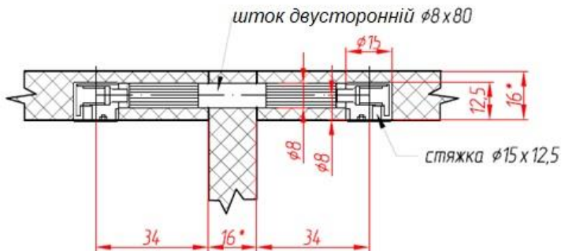
Рисунок 9.20 - Схема двостороннього ексцентрикового стягування
