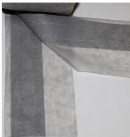
Рисунок 1.18. Комбінована клейова прокладка: 1 – клейова та неклеєва; 2 – подвійна клейова.
