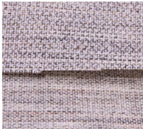
Рисунок 1.17. Бортовка клейова прокладка
