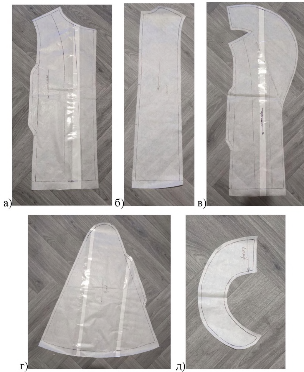
Рисунок Б.1 Комплект лекал: а) пілочка (правої сторони); б) спинка; в) пілочка (лівої сторони); г) рукав; д) комір
