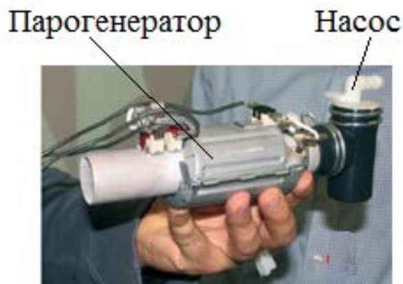
Рисунок 1.2 Генератор пари проточного типу пральної машини Whirlpool [16]
