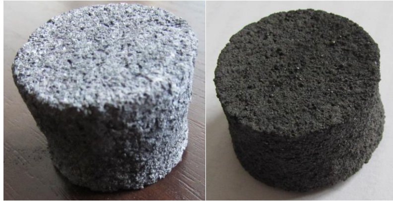
Рисунок 3.11 – Дослідні зразки, спечені в режимі СВС
