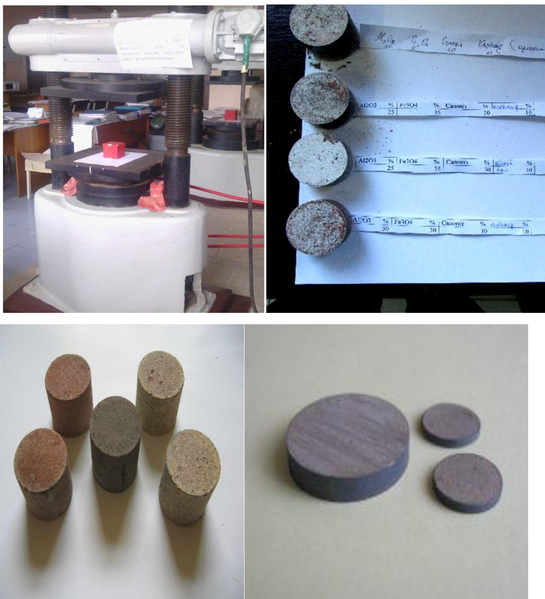
Рисунок 3.9 – Загальний вигляд пресу марки ПСУ – 125 та дослідних зразків
