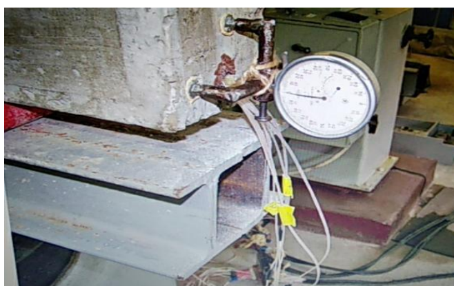
Рисунок 6.6. Кріплення індикатора та дротів від тензорезисторів у зразку Б2
