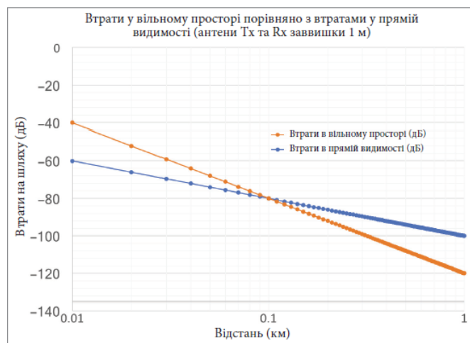
Рисунок 4.3 – Втрати у вільному просторі порівняно з плоскою землею (в дБ) з використанням сигналу 2,4 ГГц з антенами заввишки 1 метр
