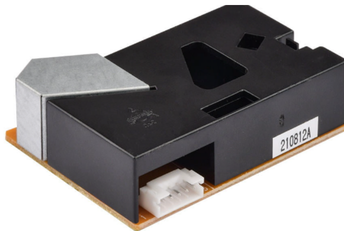
Рисунок 2.9 – Датчик пилу DSM501A [32]
