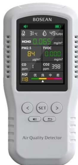
Рисунок 1.5 – Монітор якості повітря Bosean T-Z01 [17]
