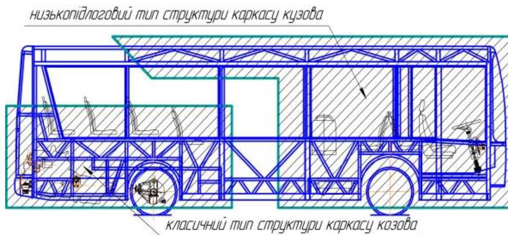
Рисунок 1 – Структурне подання типової концепції кузова
