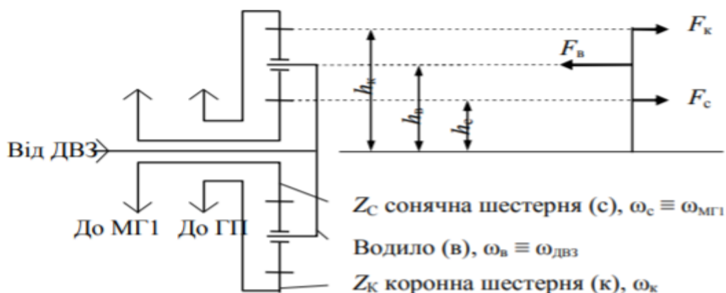
Рисунок 5 – Схеми планетарного механізму і зусиль у полюсах зачеплення та осі сателітів.
