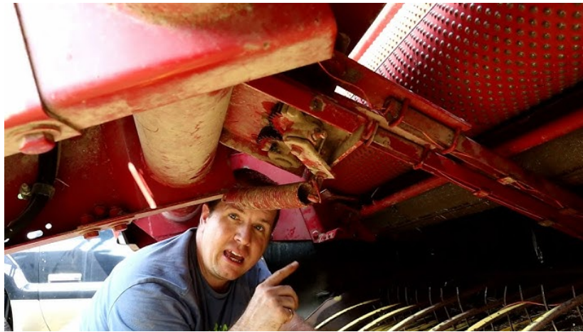
Рисунок 3.2 – Оглядати будь-які рухомі елементи можна лише після повної зупинки роботи підбирача
