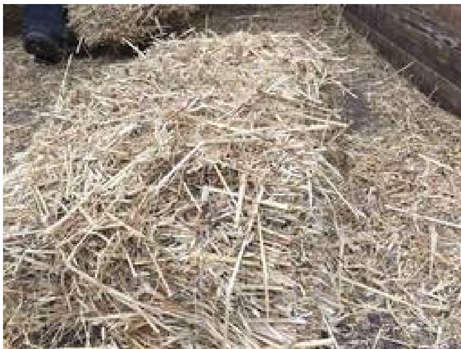
Рисунок 1.19 – Погано зав’язаний тюк, який розсипався після виходу з підбирача
