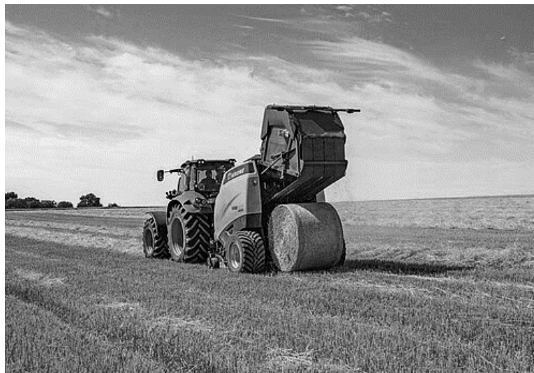
Рисунок 1.3 – Рулонний прес-підбирач Krone створює циліндричний тюк [4]
