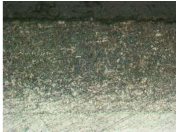
Рисунок 4.2 – Структура поверхні експериментальних зразків зі сталі 5ХГС після карбонітрації та гартування ( \times 500 ):
