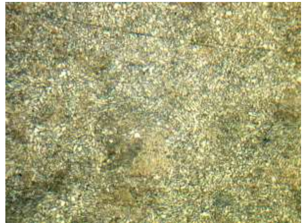
Рисунок 3.1 – Структура кованих заготовок сталі 5ХГС.
