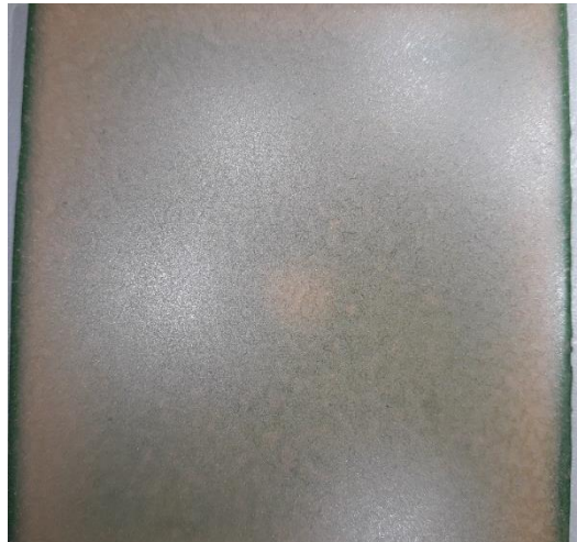
Рис. 4.14. Загальний вигляд двошарового епоксикомпозитного покриття на алюмінієвому субстраті після 20-ти циклів зміни температури
