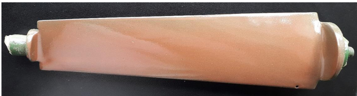
Рис. 4.10. Загальний вигляд епоксикомпозитного покриття на лопатці вхідного направляючого апарату реактивного авіадвигуна: а – адгезійний шар; б – експлуатаційний шар
