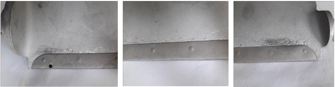
Рис. 4.3. Загальний вигляд лопатки вхідного направляючого апарату реактивного авіадвигуна (а) з ділянками руйнування (б) поверхні: 1 – корпус лопатки зі сплаву марки ВД-17; 2 – накладки зі сталі марки 12Х18Н10Т
