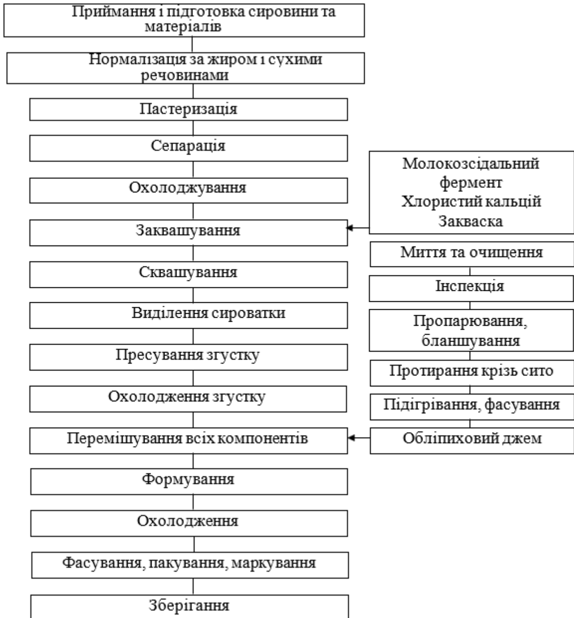
Рисунок 2.1 - Технологічна схема виробництва десертів сиркових з обліпихою
