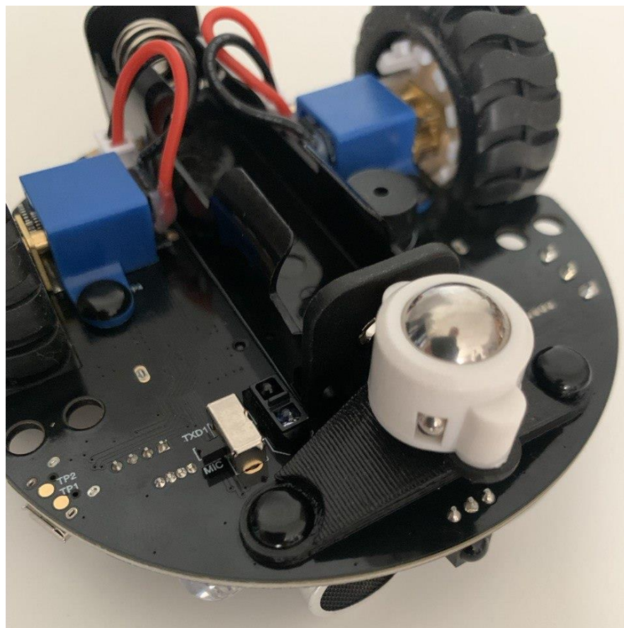
Рисунок 3.11 – З'єднання універсального колеса до плати
