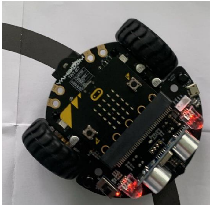
Рисунок 3.24 – Представлення роботехнічної системи з рухом по чорній лінії
