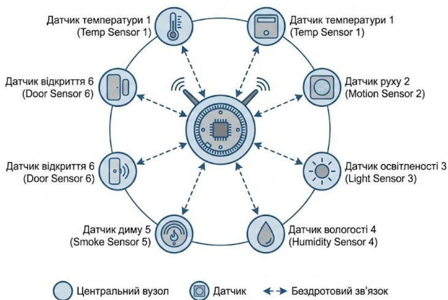
Рисунок 2.2 – Організація мережі датчиків за топологією «Зірка» [15]
