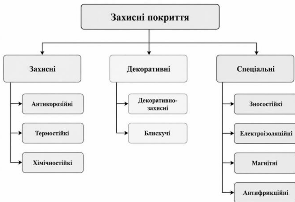
Рисунок 1.1 – Класифікація захисних покриттів
