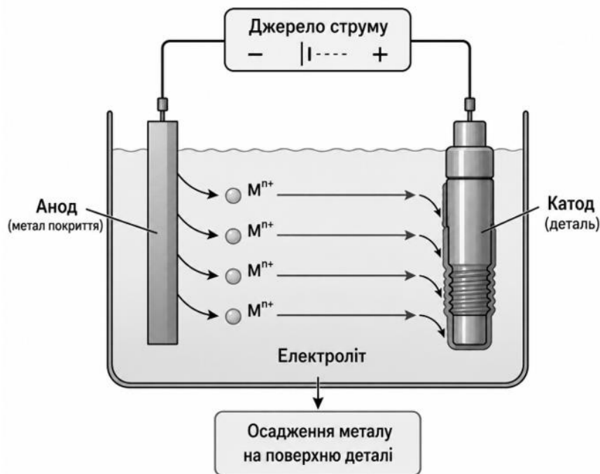
Рисунок 1.2 – Схема процесу електролітичного осадження
