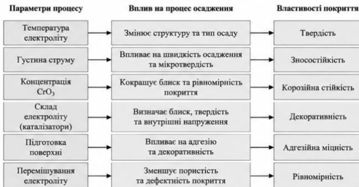
Рисунок 2.2 – Вплив параметрів процесу на властивості покриття
