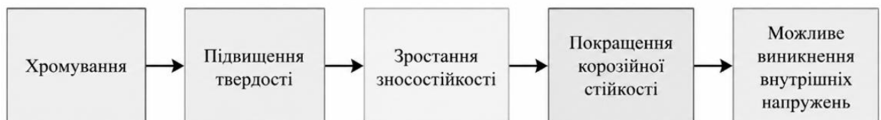
Рисунок 4.2 – Очікувані результати після хромування
