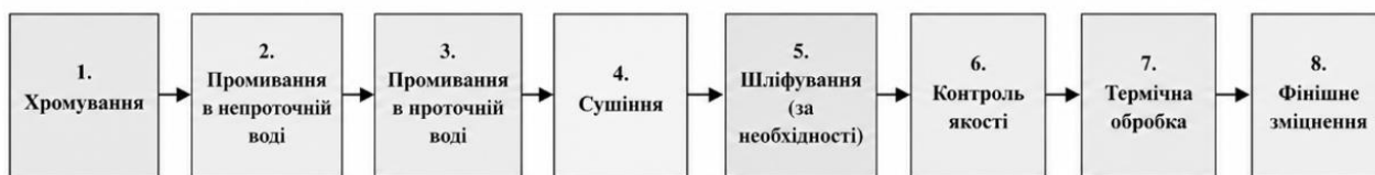
Рисунок 2.4 – Послідовність технологічних операцій після хромування
