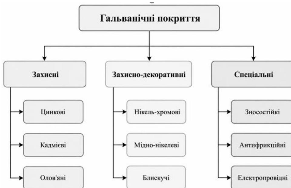
Рисунок 1.4 – Класифікація видів гальванічних покриттів
