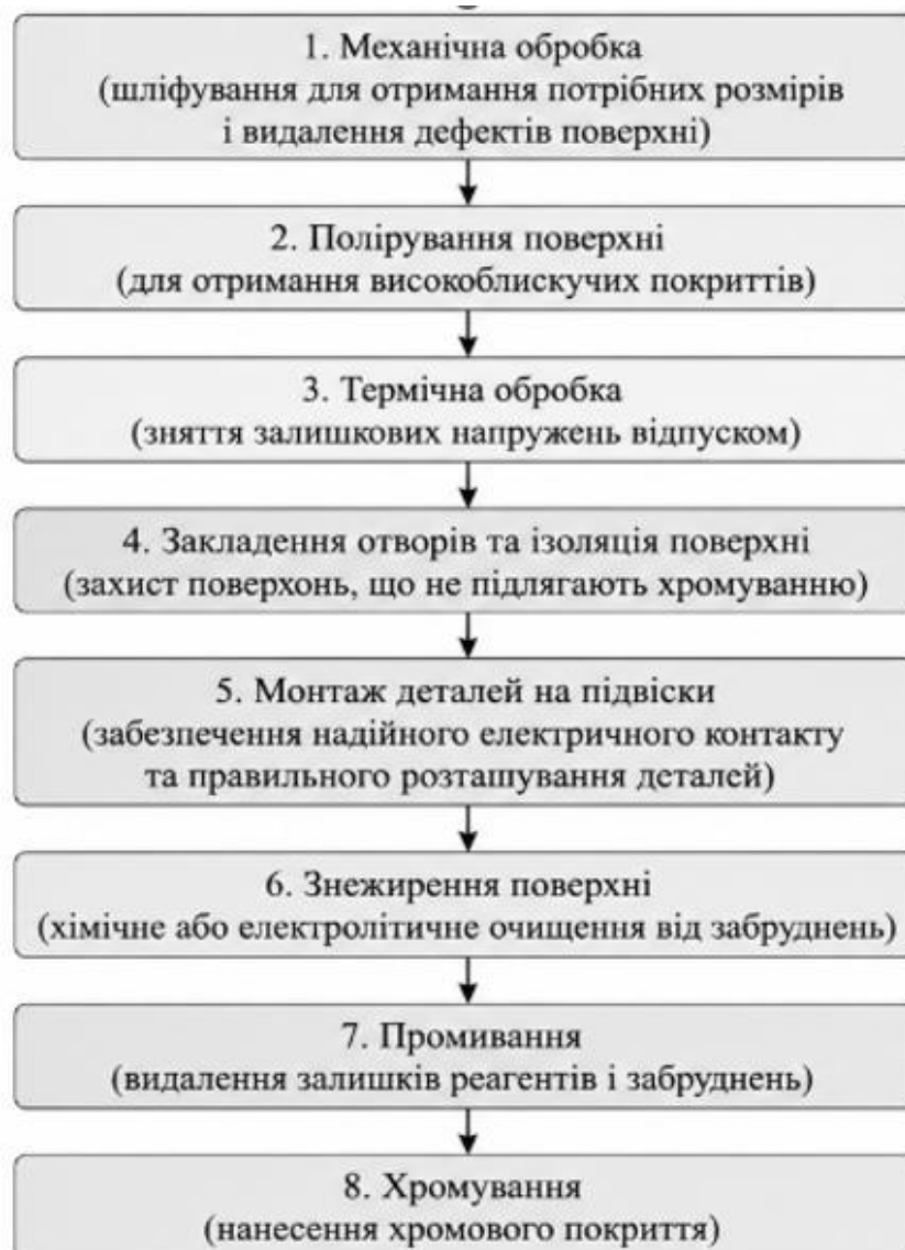
Рисунок 2.2 – Послідовність підготовки поверхні деталей до хромування
