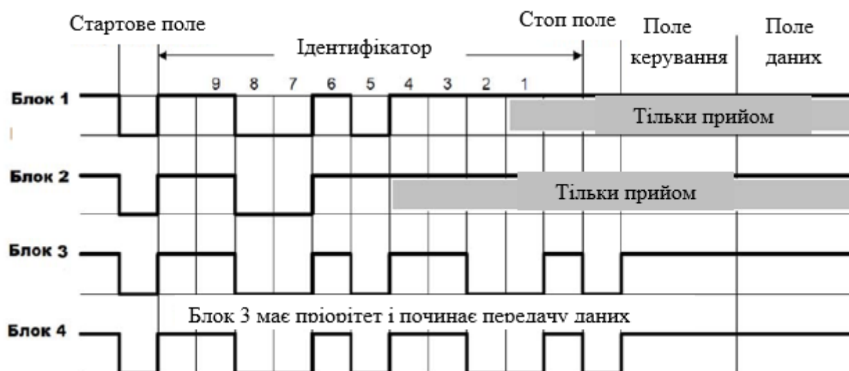
Рисунок 4.5 – Процедура арбітражу в шині
