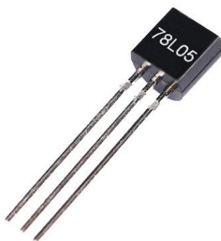
Рисунок 2.7 – Лінійний стабілізатор 78L05 [10]
