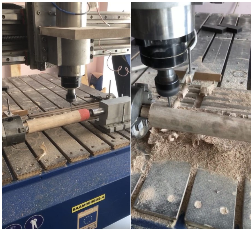
Рисунок 5.6 – Виготовлення макету на верстаті з ЧПУ
