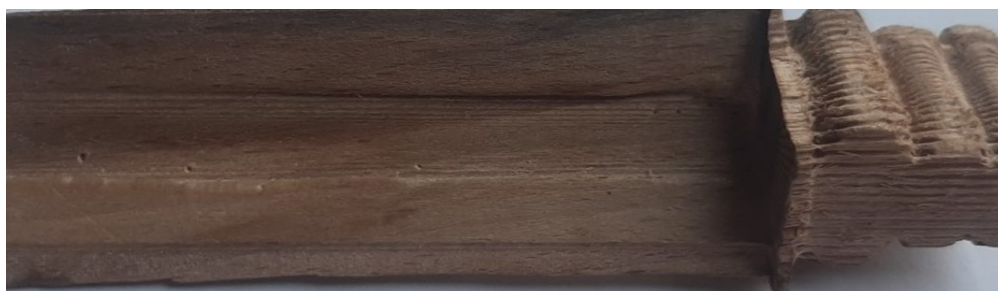
Рисунок 5.7 – Результат обробки дерев'яного макету лопатки заготурбінного двигуна
