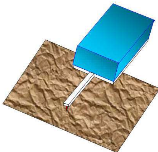
Рисунок 4.9 – Загальний вигляд зондового АСМ датчика з одиночною консоллю прямокутного перерізу
