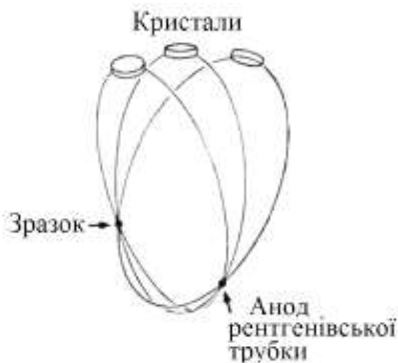
Рисунок 7.16 – Умовна схема обладнання рентгенівського монохроматора із трьома колами Роуланда, використовувана для підвищення інтенсивності монохроматичного рентгенівського випромінювання
