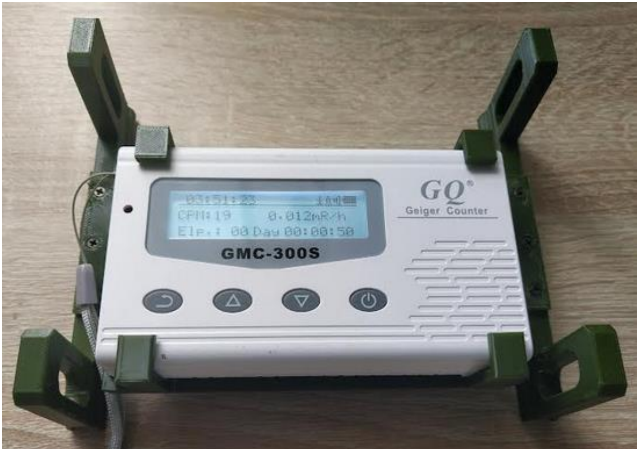
Рисунок 3.3. Дозиметр у власно сконструйованому підвісі до БПЛА DJ1 Phantm4
